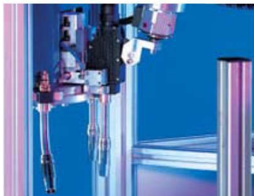
5 Gatul de schimb este blocat in pozitie. Conectarea se face automat, dupa care robotul se muta de la statia de schimb si continua.
