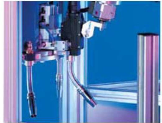
2 Mecanismul de eliberare a capului este angajat si sarma este taiata in interiorul corpului pistolului.
