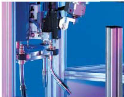
3 Gatul pistolului este preluat prin miscarea in jos a suportului rotorului. Conectorii rapizi impiedica scurgerea lichidului de racire.
